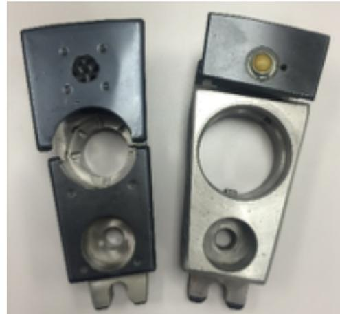
Figure 2: 114 style die holder (L); Retractable die holder (R).
